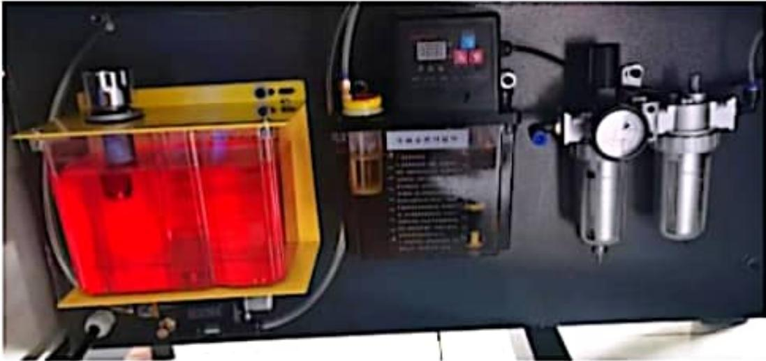
**四、 接气：**将 8mm 气管接入机床油水分离器内，打开气源。
