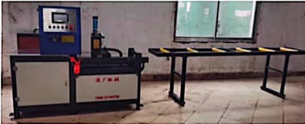
**四、油液添加：**1、将润滑泵油箱加入 3 升 46 号导轨油。
